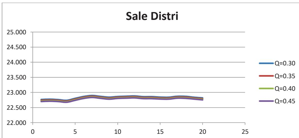
Figura 28 Ángulos de flujo a la salida del distri para apertura de 26°
