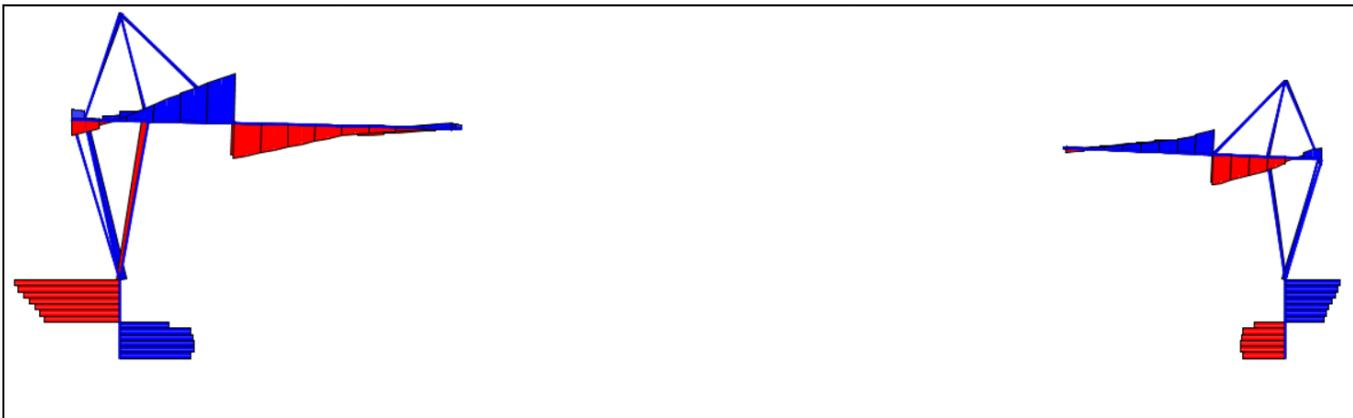
*Figura 41. Esfuerzo de corte debido a cargas de succión*
