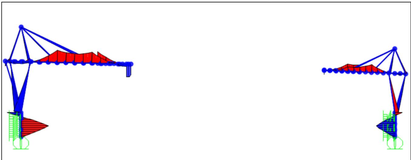
*Figura 31. Diagramas de momento debido a cargas gravitatorias para una línea estructural*
