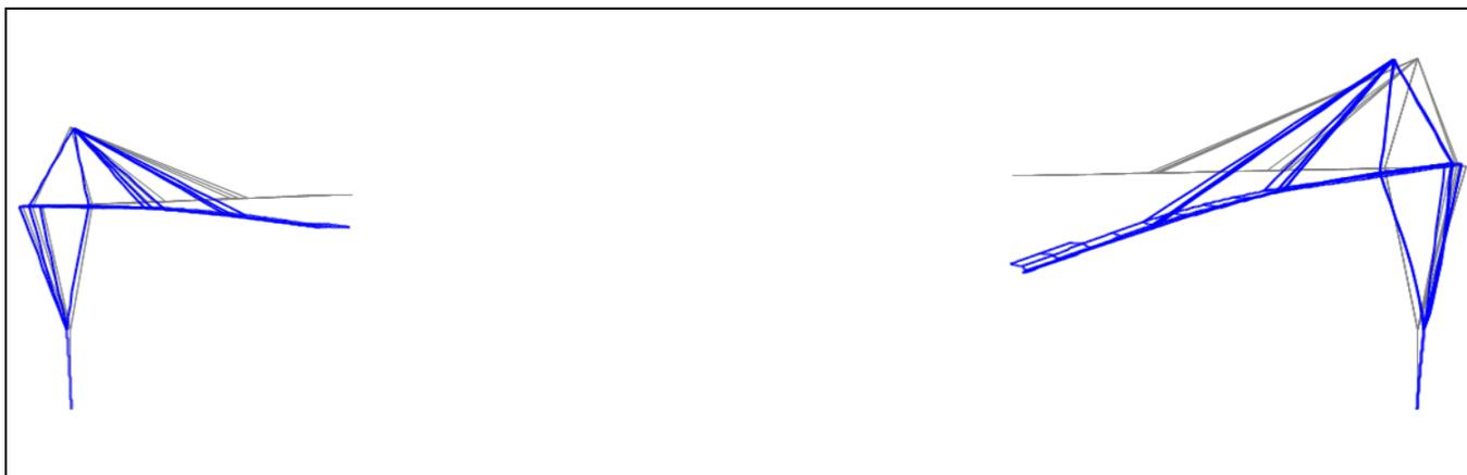
*Figura 57. Deformada línea estructural para cargas gravitatorias*
