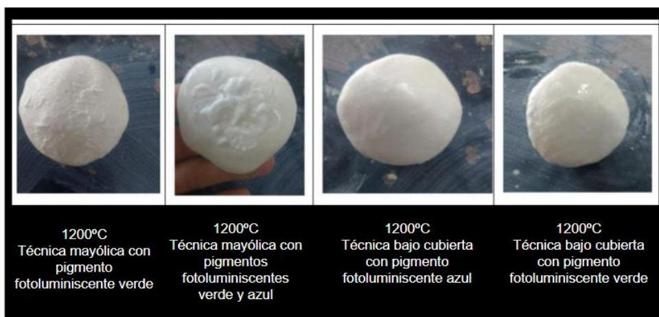
En conclusión los resultados obtenidos determinan que estos pigmentos no son aptos, en estos esmaltes de alta temperatura. Por ende se procede a testear los pigmentos en su estado puro para evaluar cual es el límite y la temperatura óptima de trabajo, que no coincide con lo informado por el proveedor (1400°C).
