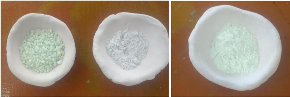
A continuación el proceso consiste en colocar en varios contenedores de cerámica los dos pigmentos en pellet y molidos # 325 / 250, los cuales van a temperaturas de 900°C, 950°C, 1000°C y 1070°C en una pequeña mufla de la facultad. Por otro lado, los cristales gruesos fueron sometidos en un microondas en el interior de casetas refractarias a temperaturas de 800°C, 900° C, 1100°C, 1200°C y 1350°C.
