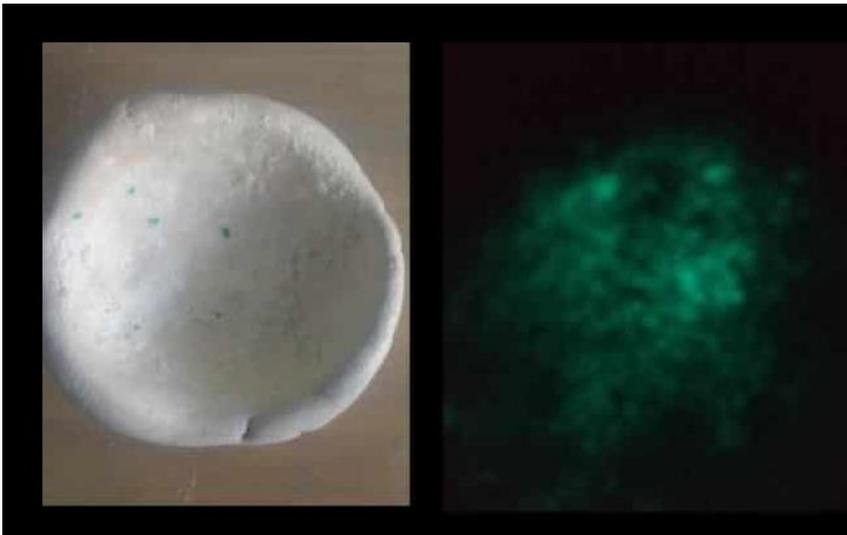
La cuarta muestra, base alcalina # 100 / 70) que se coloca en otra cápsula, a cocción en microondas durante 18 minutos, (medición observada 42 mV), equivalente a 1018°C.
