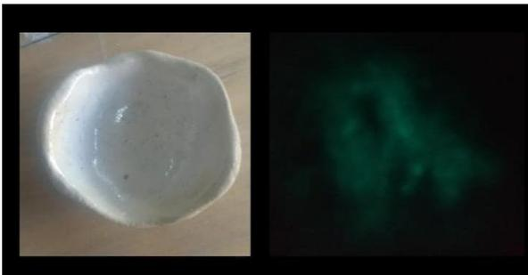
Para la siguiente experimentación se procede de la misma forma anterior, pero utilizando en este caso la probeta con base plúmbica (# 100/70), se lleva a 14 minutos en microondas, obteniendo una medición de 34 mV, equivalente a 818°C, por lo que se le suman 5 minutos obteniendo de esta forma una mayor medición, 38,4 mV, equivalente a 927°C.
