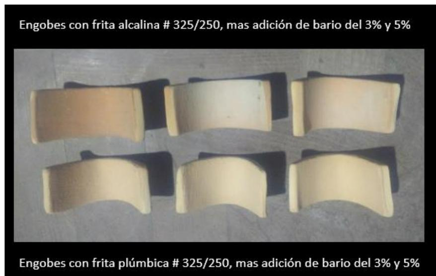
Observando la figura 30, las probetas luego de ser expuestas a los rayos UV, no presentan luminiscencia a simple vista (en el ejemplo se observan probetas con esmaltes alcalinos - plúmbicos, más los pigmentos fotoluminiscentes (# 325 / 250) y 3% o 5% de carbonato de bario. Ambos engobes (plúmbico- alcalino) queman color naranja.
