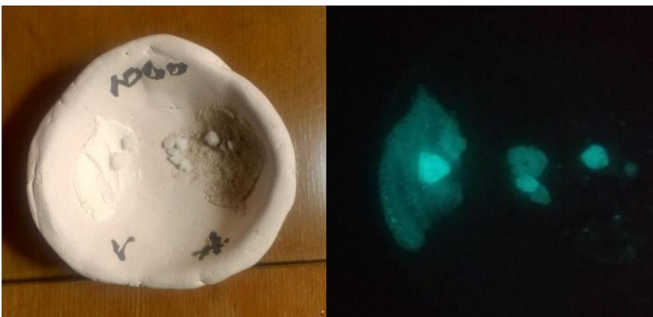
En la figura 9, se encuentran dispuestas las probetas sometidas a las siguientes temperaturas 1070°, 1100°C, 1200°C. Dado que se observa que a partir de los 1000°C cae abruptamente la intensidad lumínica emitida por los pigmentos en ambas granulometrías, es por ello que se decide someter ambos pigmentos en pellet a partir de 1100°C
