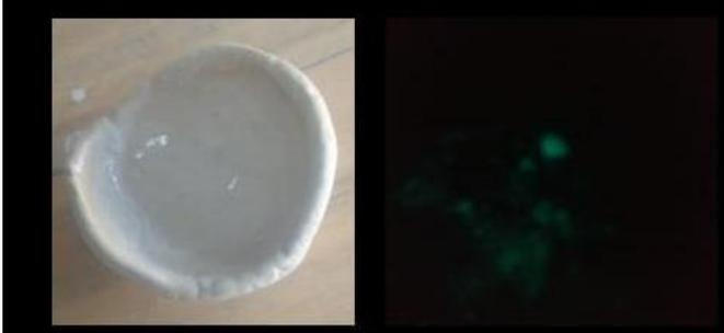
Finalmente se realiza la cocción de dos probetas en una misma cápsula refractaria con base plúmbica y con los pigmentos fotoluminiscentes de dos granulometrías (# 325 / 250 y # 180/150), obteniendo una medición de 31,3 mV, equivalente a 753° C, se le suman 8 minutos para llegar a la temperatura deseada, obteniendo así una medición de 35,3 mV, equivalente a 850°C.
