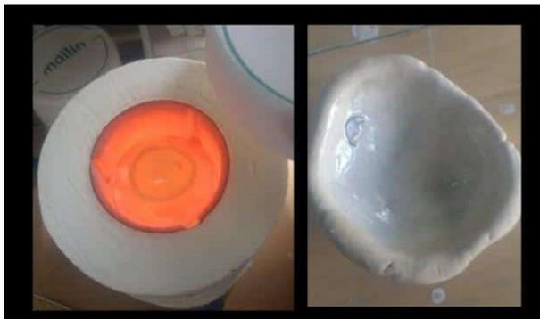
Se procede de la misma forma con base alcalina # 180/150 y se le da un tiempo de 15 minutos en microondas, ver figura 17. En este caso la medición da 31, 8 mV equivalente a 765° C, se le suman 3 minutos para tratar de llegar a los 900°C (temperatura de estudio), midiendo en este caso 33,3 mV, equivalente a 801° C; al no llegar a la temperatura buscada, se le suma 4 minutos más, obteniendo una medición de 38 mV, equivalente a 917°C.
