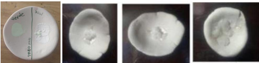
Entre los 1070°C y hasta los 1200°C todos dejan de emitir luz. Los pigmentos sometidos a la mayor temperatura se hornearon en microondas ya que no se dispone de mufla para esta temperatura. Se percibe que los cristales sometidos a los 1200°C funden, tomando un aspecto translúcido como el vidrio, la energía calorífica absorbida fue mayor en este caso.
