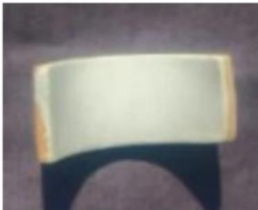
Evaluando los resultados obtenidos en las muestras anteriores, se puede deducir lo siguiente: la emisión fotoluminiscente de los pigmentos en la técnica de engobe se ve entorpecida por la presencia de partículas arcillosas, observándose una coloración azul verdosa con luminosidad muy disminuida que se manifiesta sólo en la superficie.
