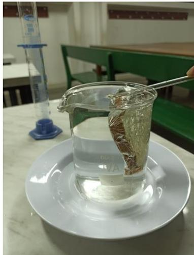
**FIGURA 21.** MEDICIÓN DE VOLUMEN ESPECÍFICO. FUENTE: FOTOGRAFÍA PROPIA
