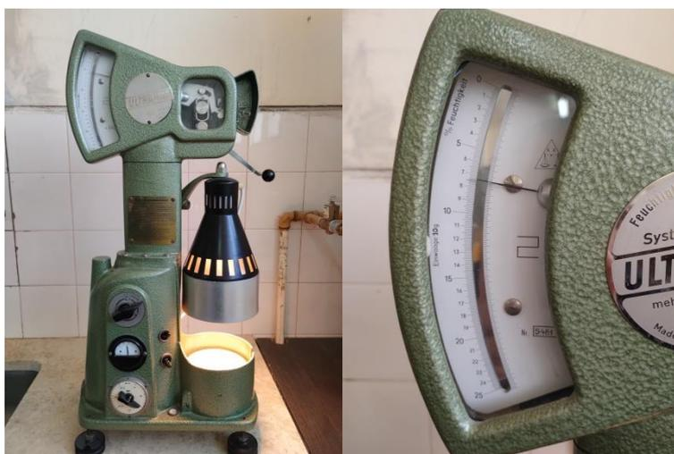
FIGURA 20. EQUIPO DE MEDICIÓN DE CONTENIDO DE HUMEDAD. FUENTE: FOTOGRAFÍA PROPIA
