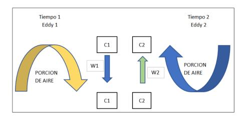
**Figura 5:** Esquema de los movimientos de aire debido a los Eddys, adaptado de Burba (2013**).**
