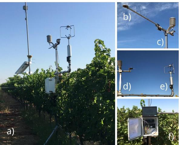
Figura 7: a) Estación agroclimática de configuración Surface Renewall "full", b) Piranómetro , c) sensor de la temperatura y humedad relativa del aire, d) Termocupla (0.076 mm de diámetro ), e) anemómetro sónico, f) datalogger (CR1000, Campbell Scientific Inc., Logan, UT, USA)
