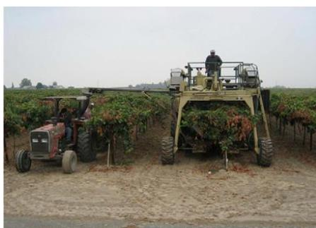
Figura 3: Cosecha mecánica sobre Open Gable en California- USA. Fuente: Fidelibus, 2014.
