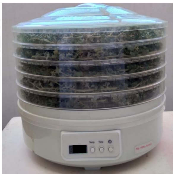
Figura 13. Horno deshidratador de pequeña escala. Fuente: Fotografía propia.
