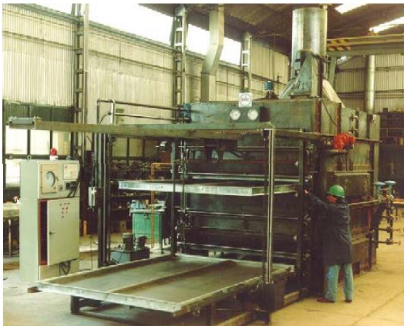
Figura 5. Horno deshidratador discontinuo Tecnología 'Schilde'. Fuente: Gascón A. et al. , 2013, "Desecación y deshidratación de vegetales" Cátedra de Industrias Agrarias - Departamento de Ciencias Enológicas y Agroalimentarias, FCA, UNCuyo.
