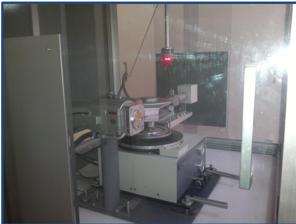
Figura 2.9. Equipo empleado para análisis de muestras por difracción de rayos X.
