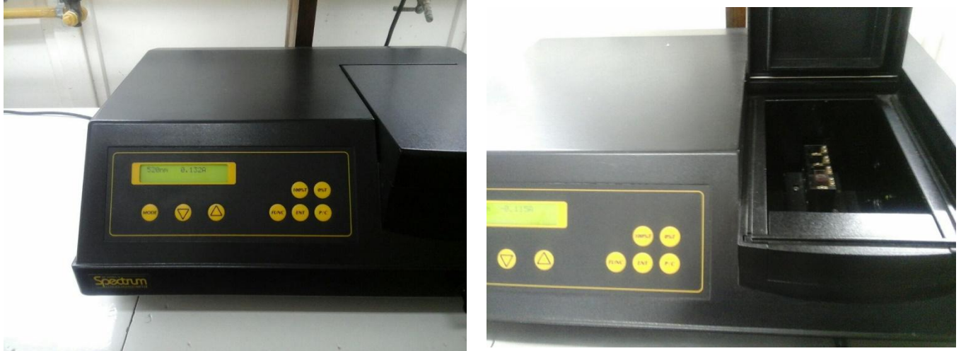
Figura 16. Espectrofotómetro Spectrum SP 1105. Compartimiento para 4 posiciones de cubetas
