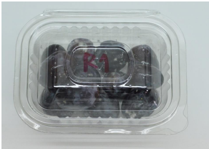
Figura N° 4: Bayas envasadas en la cubeta de PET sin perforar.
