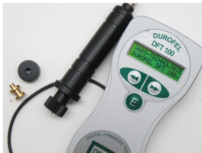
Figura N° 8: Equipo Durofel utilizado para medir firmeza en las bayas.
