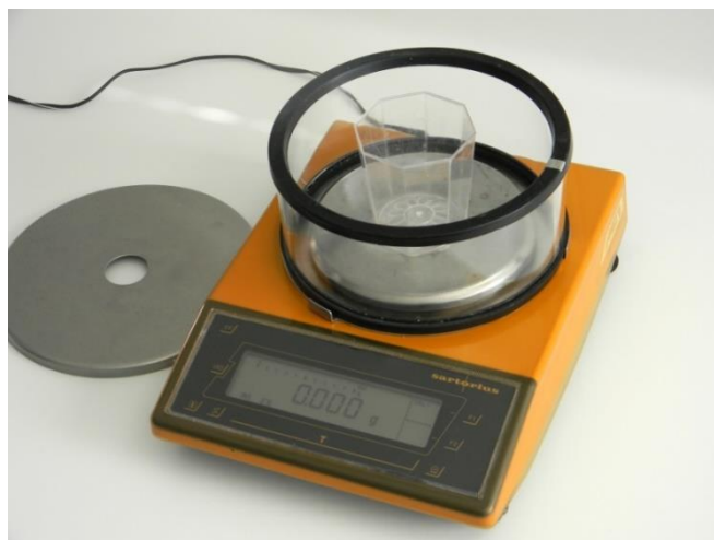
Figura N° 6: Balanza de precisión para la determinación de pérdida de peso.
