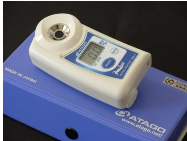
Figura N° 7: Refractómetro digital utilizado para medir sólidos solubles.
