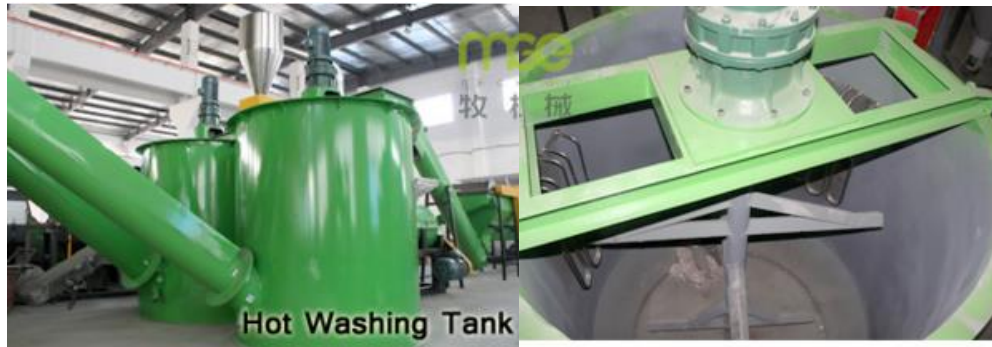
Figura 4.12: tanque de baño de sosa cáustica
