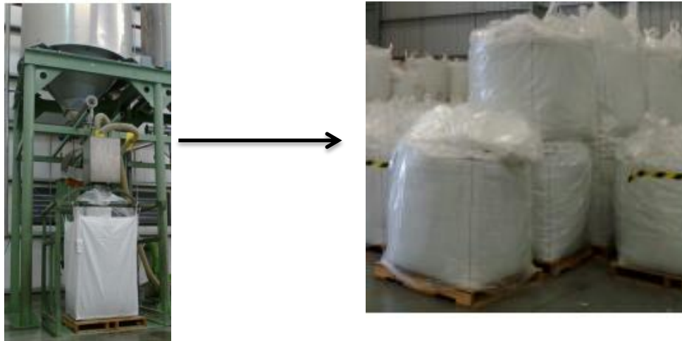
Figura 7.18 Llenado de los sacos con pellets grado alimenticio
