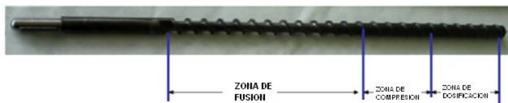
Figura 4.39: Zonas del husillo: fusión, compresión, dosificación.
