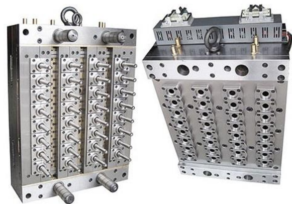
Figura 6.42: Matrices de preformas 55 gramos.
