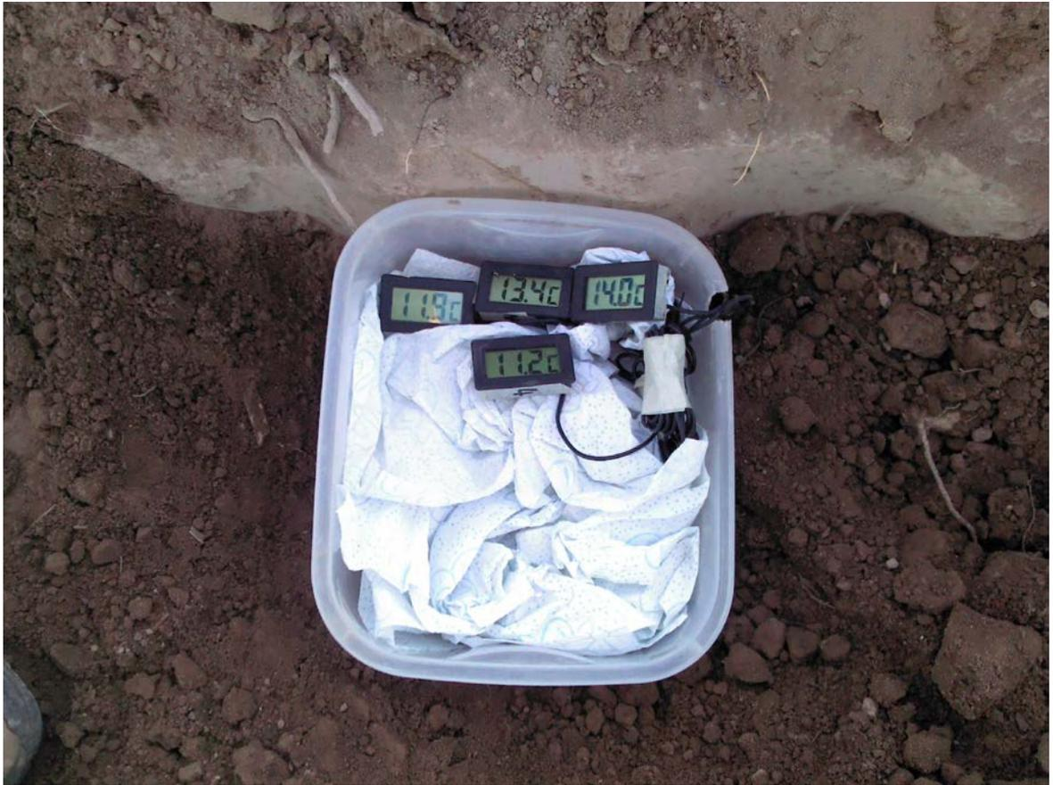
Gráfico n° 6: Termómetros de lectura directa: pantallas de lectura a la vista y bulbos de medición enterrados, previa construcción de casilla protectora de hormigón.
