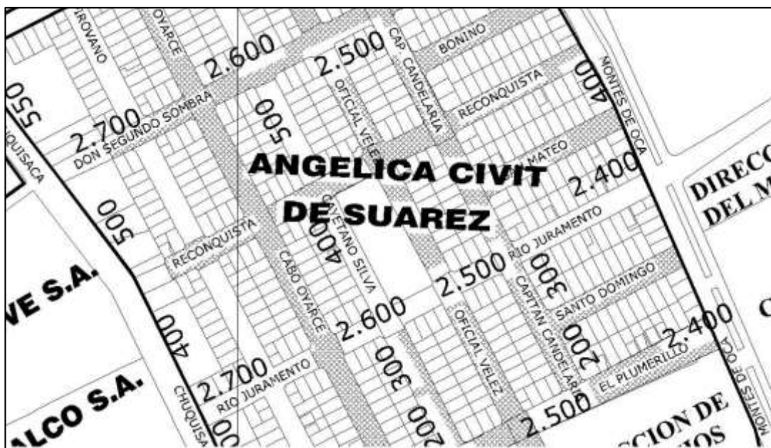
Fig. 34 Plano con las calles asfaltadas marcadas
